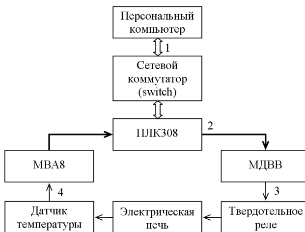
Рис. 2. Структурная схема САУ: 1 – кабель Ethernet; 2 – кабель RS-485; 3 – широтно-импульсный сигнал (ШИМ); 4 – сигнал обратной связи
